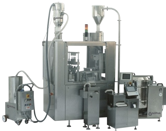
Transportador neumático (izquierda) y empujador de cápsulas (derecha), en una empresa farmacéutica.
