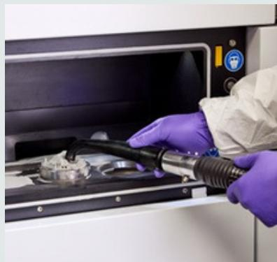
Los modelos diseñados para la eliminación segura ofrecen protección óptima al operario durante el proceso de eliminación de polvos peligrosos.
