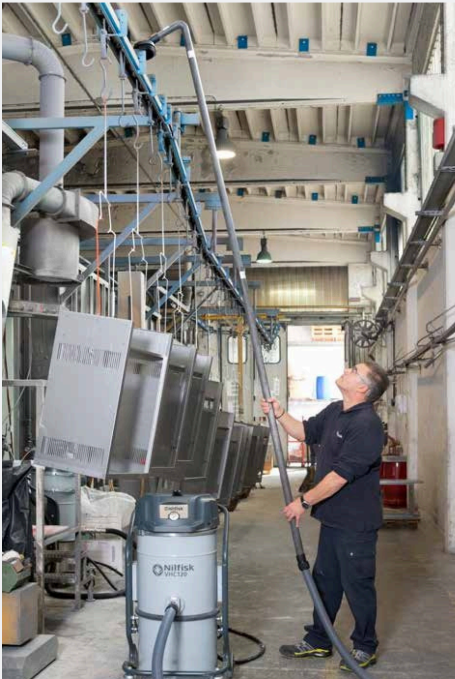
Modelo VHC110 ATEX equipado con los nuevos accesorios ATEX
