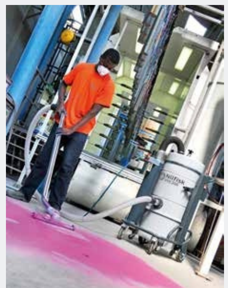
Recuperación de polvo explosivo de todas las superficies.
