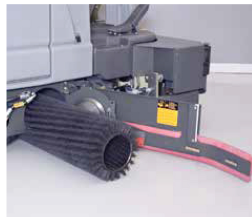
Ofrece un rápido mantenimiento gracias a que el recambio o ajuste tanto de la boquilla de aspiración, como los faldones laterales o de los cepillos gracias al sistema NoTools™.
