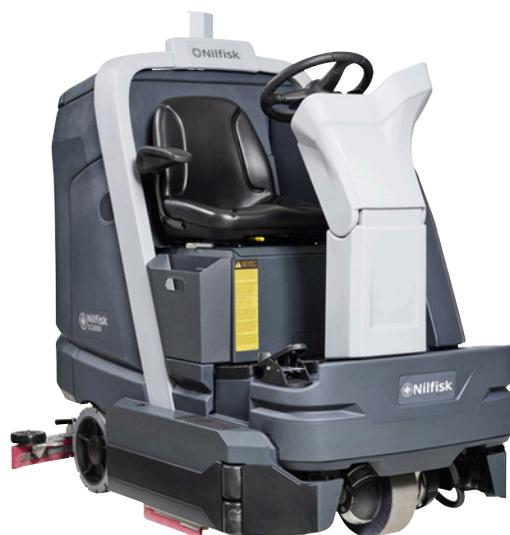
Fácil acceso al asiento del conductor desde ambos lados; posición de trabajo ergonómica y pedal de pie cómodamente colocado.
