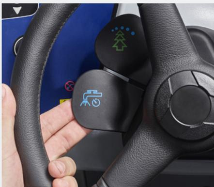
Sistema de regulación del flujo SmartFlow integrado en el volante: reduce el flujo de agua en la cubierta, evitando salpicaduras durante los giros, garantiza un consumo reducido, un perfecto rendimiento y un secado impecable
