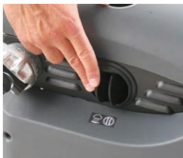
8. Cuando opere en suelos mojados, abra el "by-pass" para barrido en mojado para evitar dañar el filtro de polvo. Cierre el "by-pass" para barrido en mojado para restablecer una aspiración correcta.
