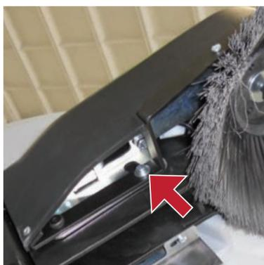
2. Ajuste la posición de los cepillo laterales utilizando el tornillo de registro.
