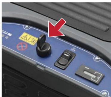
9. Suelte la palanca de tracción, levante el cepillo lateral y apague la máquina girando la llave de arranque en posición "0".
