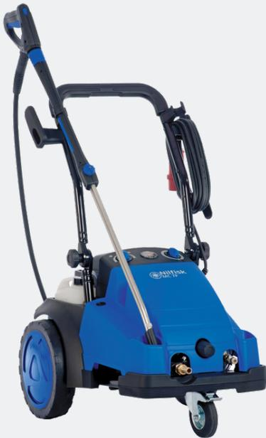
La MC 6P FA ha sido diseñada con 4 pistones cerámicos y rodamientos cilíndricos dobles para usos intensivos de hasta 5 horas diarias. La bomba NA6 está inspirada en la tradicional C3 que ofrece una máxima temperatura de entrada de agua de 80°C, esto significa que la MC 6P FA puede ser utilizada con agua caliente, reduciendo el tiempo de limpieza en muchas aplicaciones.
