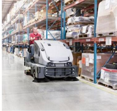
La CS7010 ofrece un rendimiento inigualable, a la vez que sustituye los sistemas hidráulicos de alto consumo y mantenimiento por la eficiente tecnología de funcionamiento eléctrico de última generación.
