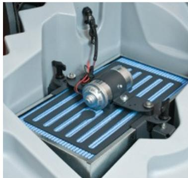
El filtro sintético Donaldson PowerCore® UltraWeb® de alta capacidad, con clasificación MERV 13 y agitador de frecuencia variable, ofrece una superior retención de polvo y suciedad en un diseño más compacto. Esto se traduce en una vida útil más prolongada del filtro y un control del polvo significativamente mejorado en comparación con los filtros convencionales de pliegues.
