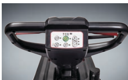
El panel de control intuitivo proporciona control sobre todas las funciones (modelo AS4325B)
